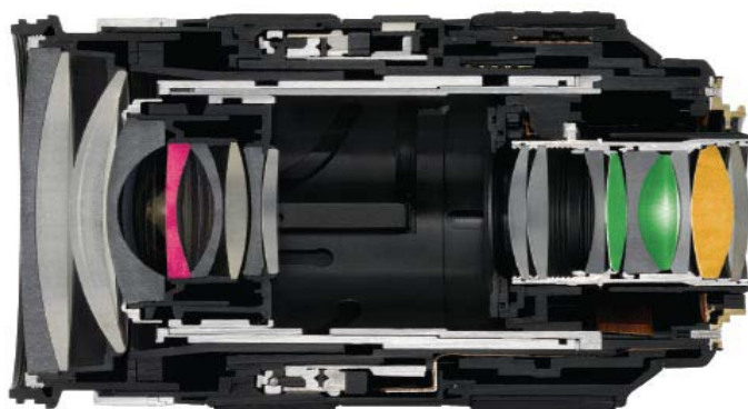
Supersonic Wave Drive (SWD): Corte transversal da objectiva, mostrando os vários elementos da objectiva, incluindo uma lente esférica (rosa), dois elementos ED (verde) e uma lente esférica de vidro ED (amarelo). Para mais detalhes ver apêndice B.
